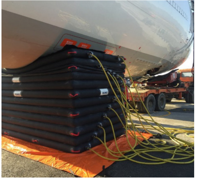
Resim 5: Uçağın hava yastığı yardımıyla kaldırılması
